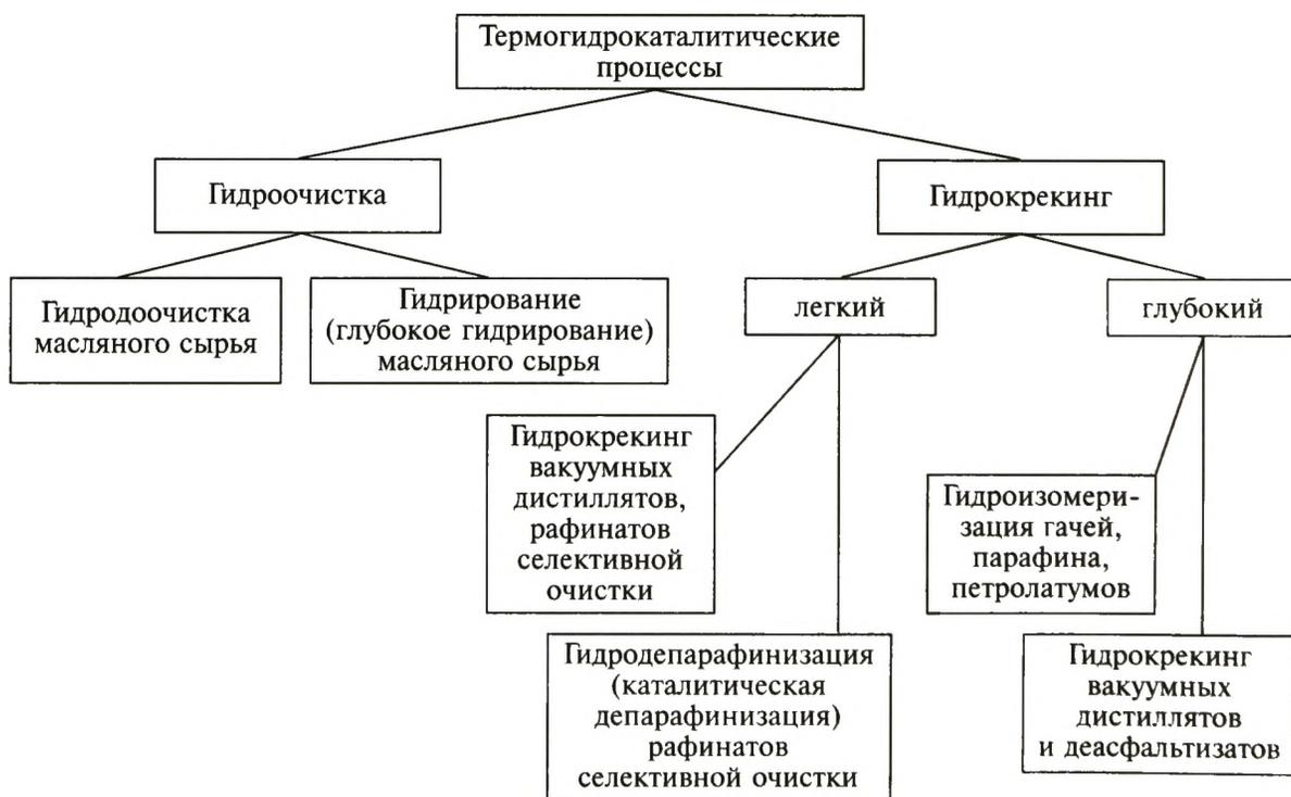
Рис. 3.51. Классификация термогидрокаталитических процессов, применяемых в производстве масел
