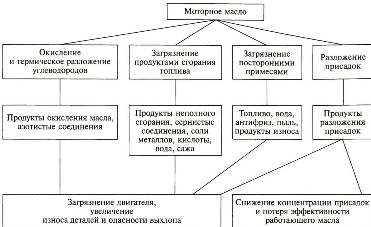
Рис. 5.1. Схема старения моторного масла
